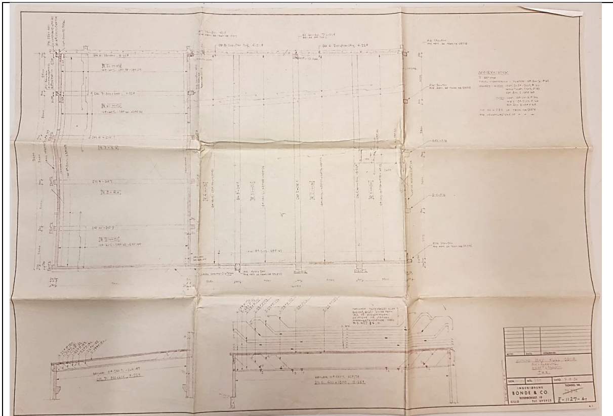
Tegninger signert Ingeniørene Bonde & Co. 07.08.1956. Plan og snitt gjennom takene (med armering) på kraftstasjonen som ble oppført året etter, inntil den gamle stasjonen. Kilde: Statsarkivet i Tromsø
