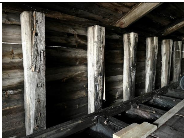
Spantene langs nordveggen i opprinnelig kullpram, med selvgrodde knær (rotkne).
